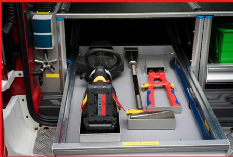
Im Geräteraum sind die unterschiedlichsten Werkzeuge übersichtlich in Laden untergebracht. Die passgenauen Halterungen ermöglichen einen sicheren Transport der Geräte und ein effizientes Arbeiten am Einsatzort.
