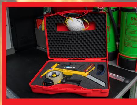
Um Fensterscheiben rasch entfernen zu können, und somit einen schnellen Zugang zu eingeklemmten Unfallopfern zu schaffen wurde ein modernes Glasschneidesystem angeschafft, welches dies ermöglicht.
