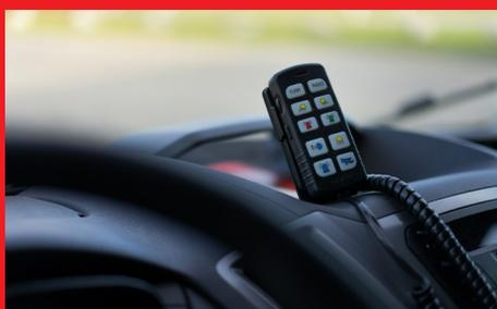
Eine moderne Signaleinrichtung sorgt für gute Sichtbarkeit und Absicherung während Einsätzen und soll als Kennzeichnung für Einsatzleitstellen dienen.
