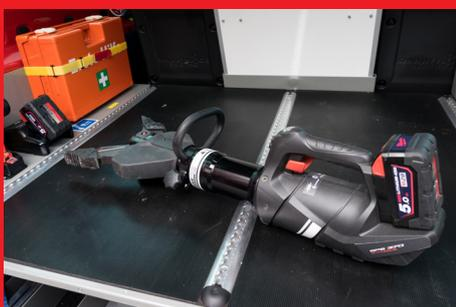
Das Herzstück des Fahrzeuges ist das Akku-Rettungsgerät der Firma Weber. Das kabellose Gerät dient zum raschen Befreien von eingeklemmten Personen nach schweren Verkehrsunfällen.
